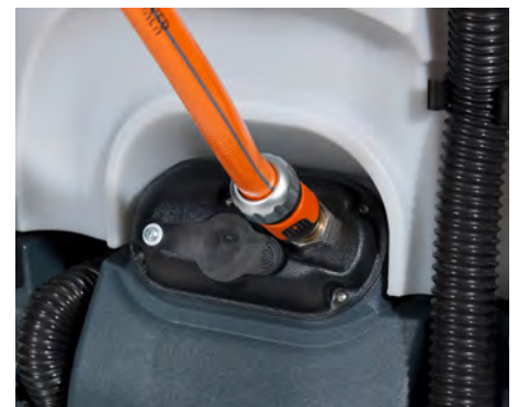
Vattenpåfyllningssystem med snabbkoppling och automatisk avbrytare när tanken är full (tillbehör).
