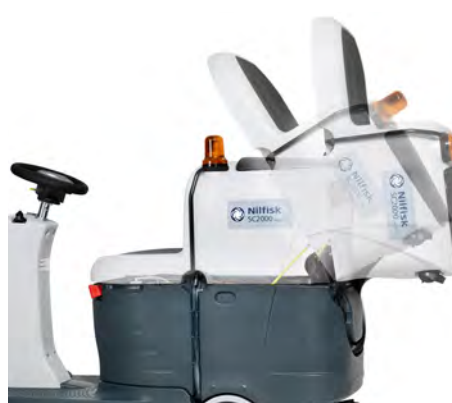
Smutsvattenstanken kan vippas, så att man lätt får tillgång till batterium och Ecoflex-systemet.
